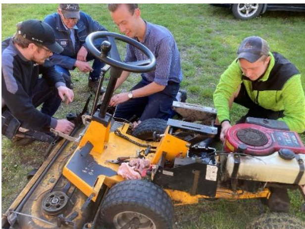
Här fixas vår gräsklippare, byte av växellåda och rep av klippaggregatet görs av Johannes, Mats, Conrad och Arvid.
